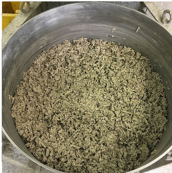
Frisch gemischter Hanfkalk. Zusammengesetzt aus Hanfschäben, Kalkhydrat und Wasser
